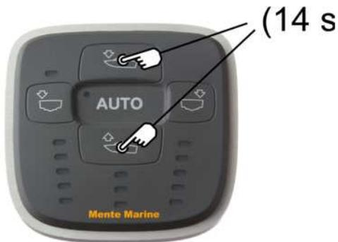
L'indicatore AUTO lampeggia per indicare che è necessaria la calibrazione. Premere i pulsanti più in alto e più in basso simultaneamente per 5 secondi per avviare la calibrazione. Tenere i pulsanti premuti per altri 9 secondi mentre l'ACS sta calibrando.
