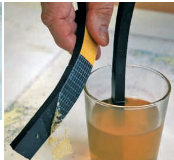
Uronili smo dva komada samoljepljive trake u naftu, ljepilo se raspalo, ali traka je ostala netaknuta
