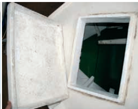
Budući da je bokaporta relativno lagana, a motor ima snažne vibracije, traka ovdje služi kao amortizer, i to vrlo učinkovito
