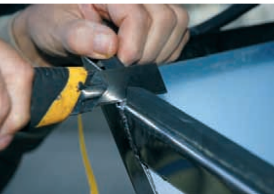
Pjenasta guma se lako reže, ali skalpel ipak mora biti vrlo oštar
