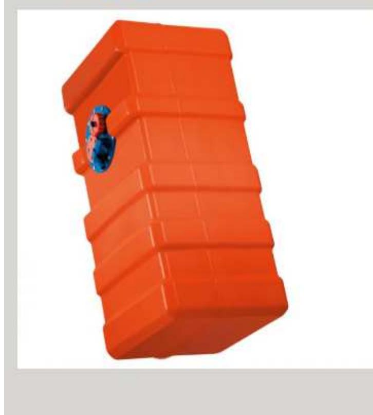
Serbatoi in polietilene alta densità, adatti agli acidi e ai carburanti, completi di boccaporto di ispezione senza indicatore. Il boccaporto è dotato di tappo con sfiato, pescante, portagomma 3/8" per sfiato aria, è inoltre predisposto per il montaggio dell'indicatore di livello elettrico o meccanico, portagomma da 1/4" per un secondo pescante per bimotore o diesel per installazioni fisse.
