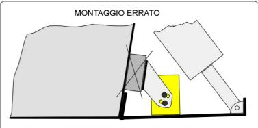
Evitare di interporre spessori fra lo specchio di poppa e il sensore, per un buon funzionamento, questo deve essere montato il piu' vicino possibile all' asse della cerniera del flap
